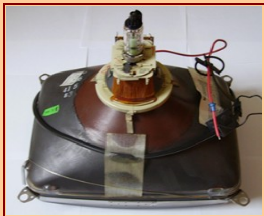
Bobinages pour balayage horizontal et vertical, générateurs de champs magnétiques.
